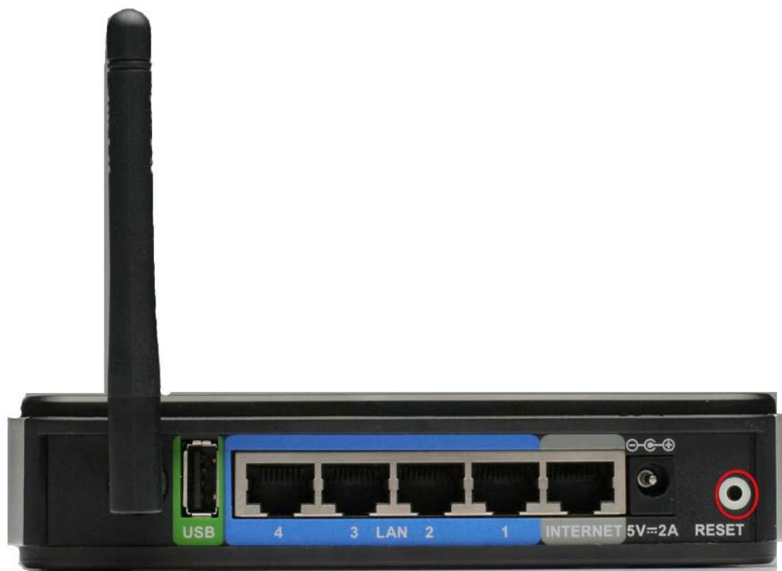
Рис. 51. Сброс маршрутизатора DIR-320 в заводские установки с помощью кнопки Reset
