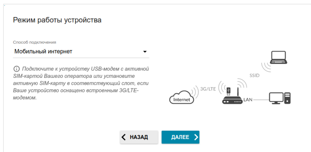
Рисунок 34. Выбор режима работы устройства. Режим Мобильный интернет .
