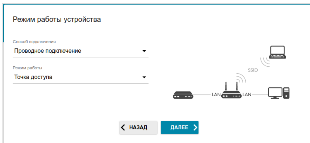
Рисунок 36. Выбор режима работы устройства. Режим Точка доступа .
