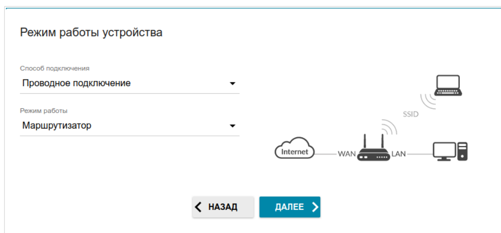
Рисунок 33. Выбор режима работы устройства. Режим Маршрутизатор .
