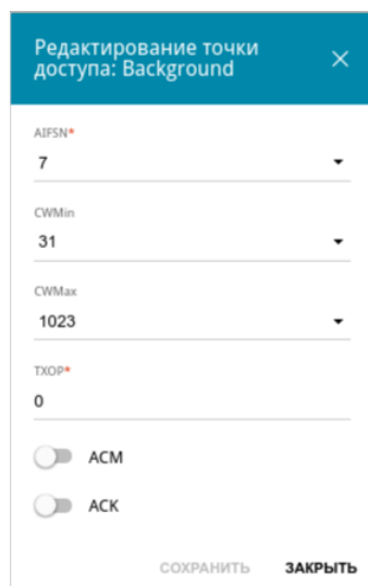
Рисунок 102. Окно для изменения параметров функции WMM.
