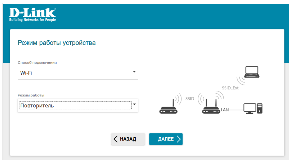
Рисунок 27. Выбор режима работы устройства. Режим Повторитель .
