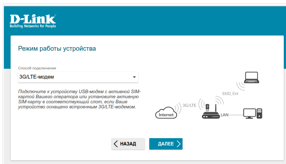
Рисунок 24. Выбор режима работы устройства. Режим 3G/LTE-модем .
