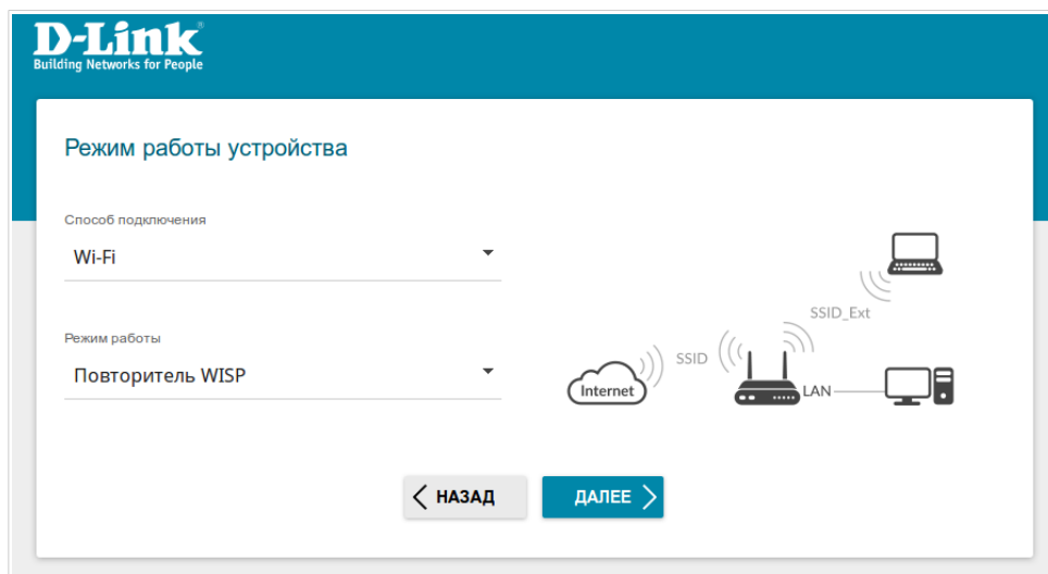
Рисунок 25. Выбор режима работы устройства. Режим Повторитель WISP .
