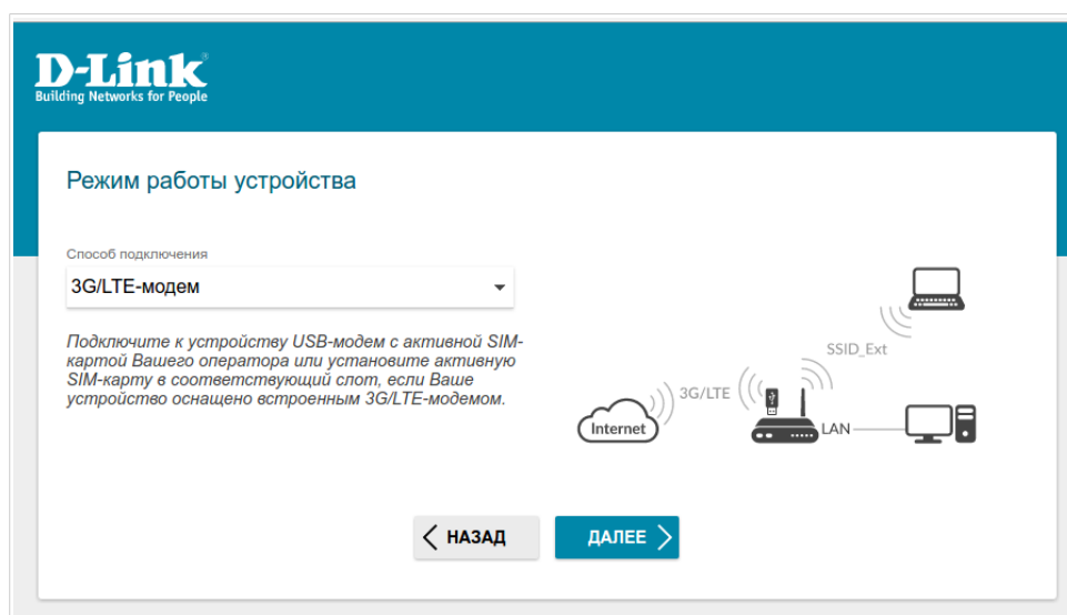
Рисунок 24. Выбор режима работы устройства. Режим 3G/LTE-модем .
