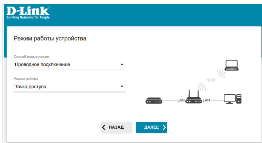
Рисунок 26. Выбор режима работы устройства. Режим Точка доступа .
