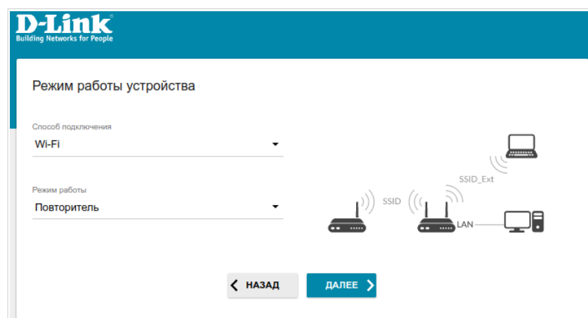
Рисунок 27. Выбор режима работы устройства. Режим Повторитель .
