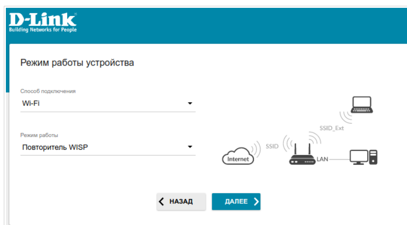
Рисунок 25. Выбор режима работы устройства. Режим Повторитель WISP .
