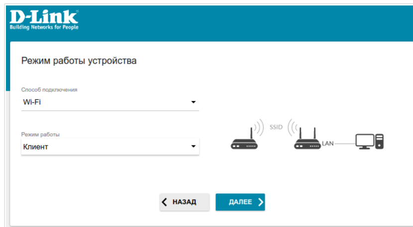
Рисунок 28. Выбор режима работы устройства. Режим Клиент .
