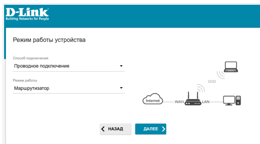
Рисунок 24. Выбор режима работы устройства. Режим Маршрутизатор .
